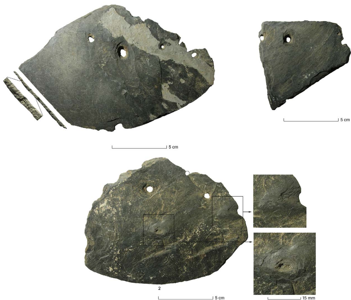
Afb. 7.4.2 Twee schubbleien en een fragment (?) uit vondstnummer 2 met details van de bekapping (linksboven) en de mogelijk geëxpandeerde ijzersulfidelensjes (onderste foto).
